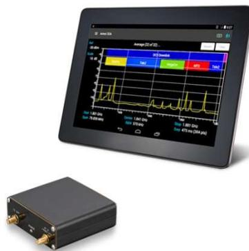
Анализатор спектра включается в измеряемую цепь. Для защиты высокочастотных разъёмов от износа, используйте переходники из комплекта поставки.
